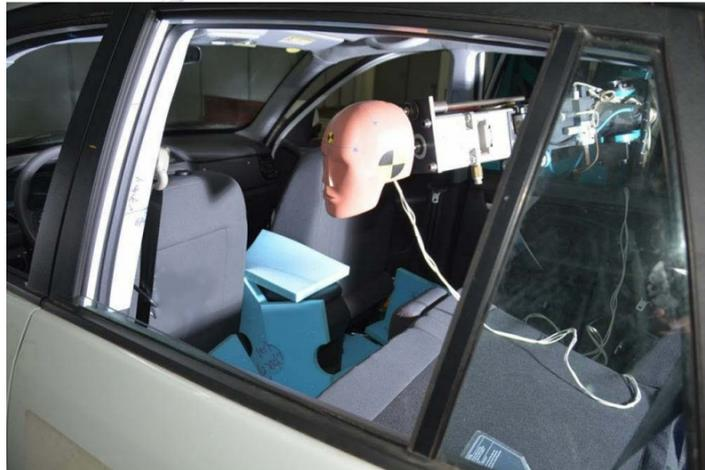
图 1 头锤冲击器及试验装置
