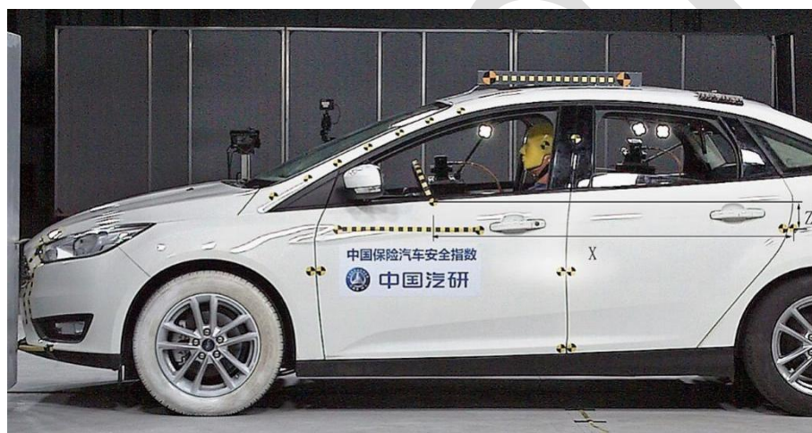
图 A. 1 后车门锁扣标识到方向盘中心标识之间距离的测量
