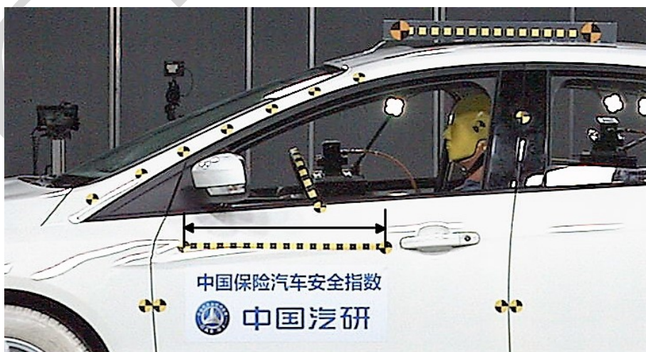
图 A. 2 车门标识之间的水平距离（61cm）
