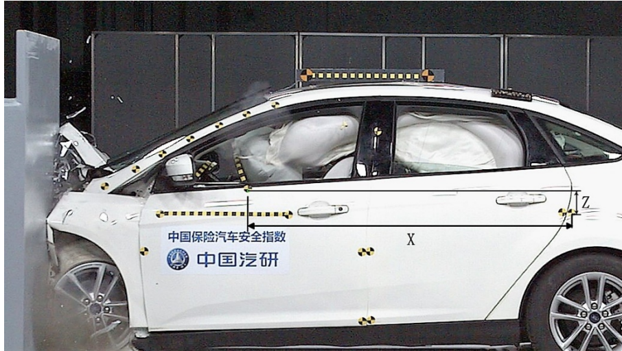
图 A. 3 标记车门上的方向盘中心（碰撞中）
