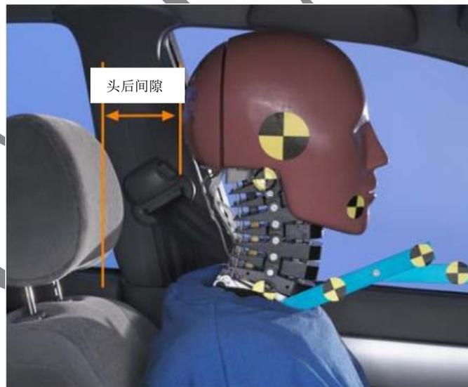
图7 测量假人的头后间隙
