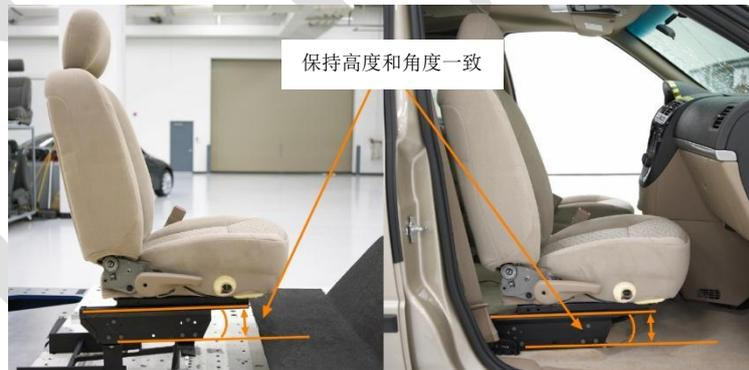
图1 座椅在车辆和台车上的安装
