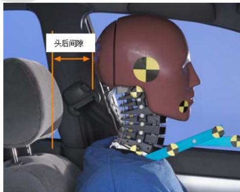
图 7 测量假人的头后间隙
