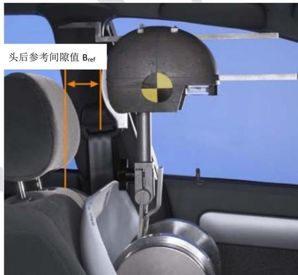
图 5 测量假人定位用的头后间隙参考值
