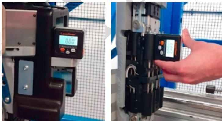
图 31 冲击器竖直状态测量
