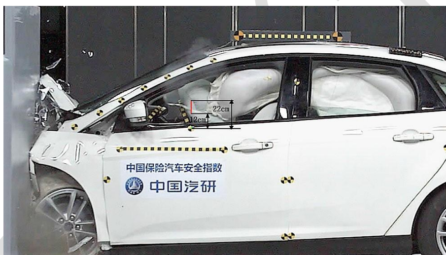
图 A.4 方向盘中心到侧面头部保护安全气囊前端的距离测量
