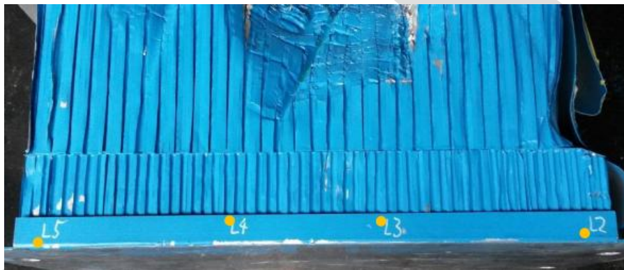
图 8 壁障变形测量还原点示意
