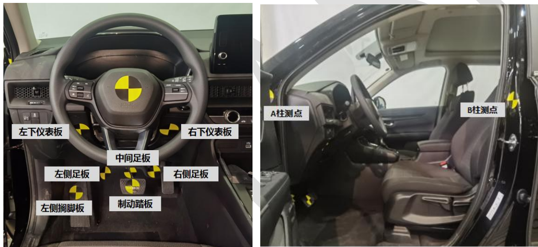
图 6 车辆侵入量测量位置示意
