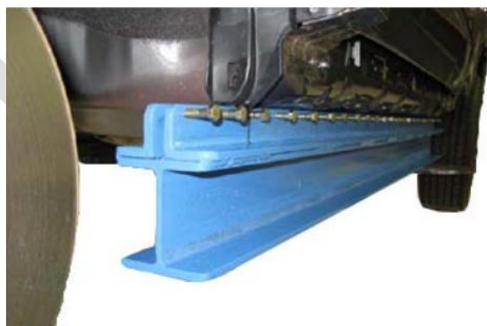
图3 车辆车门槛支撑系统（示例）
