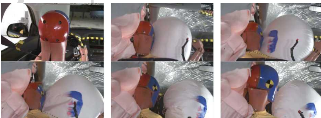
图 3 局部正面安全气囊作用示例
