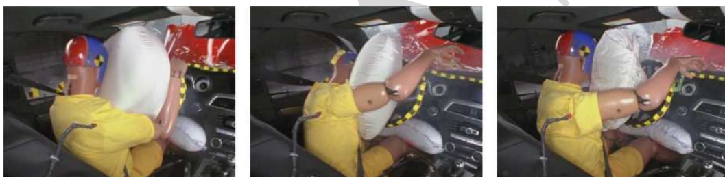
图 2 局部正面安全气囊作用示例
