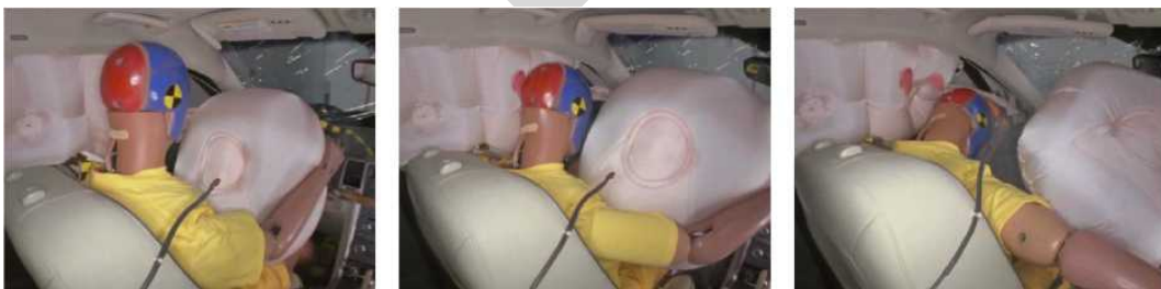
图 6 极小的正面安全气囊作用示例
