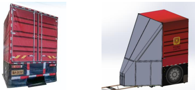
图 A.4 试验柔性目标物（静止卡车、移动卡车）
