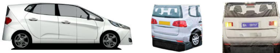
图 A.3 试验柔性目标物（3D 整车目标物、不带灯光系统、带灯光系统）
